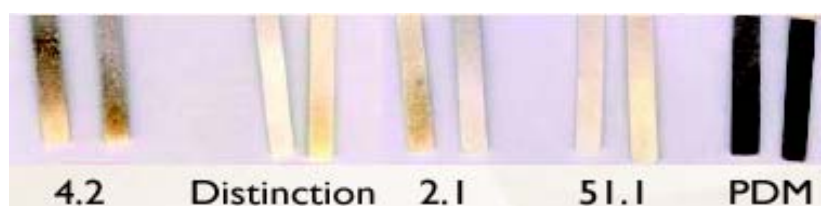
Figura 1. Strisce di carta assorbente il cui colore nero indica la presenza di piccole quantità di H 2 S
